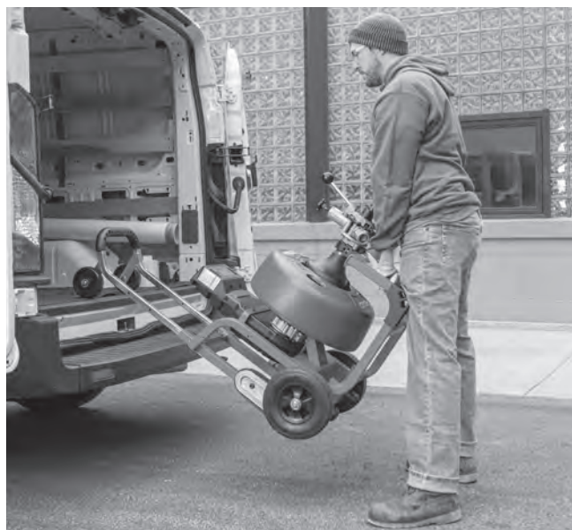
Figura 26 – Cómo subir la máquina al camión
