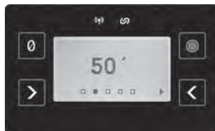
a. Écran de section de câble b. Écran de longueur de câble Figure 11 – Saisi des paramètres de câble
