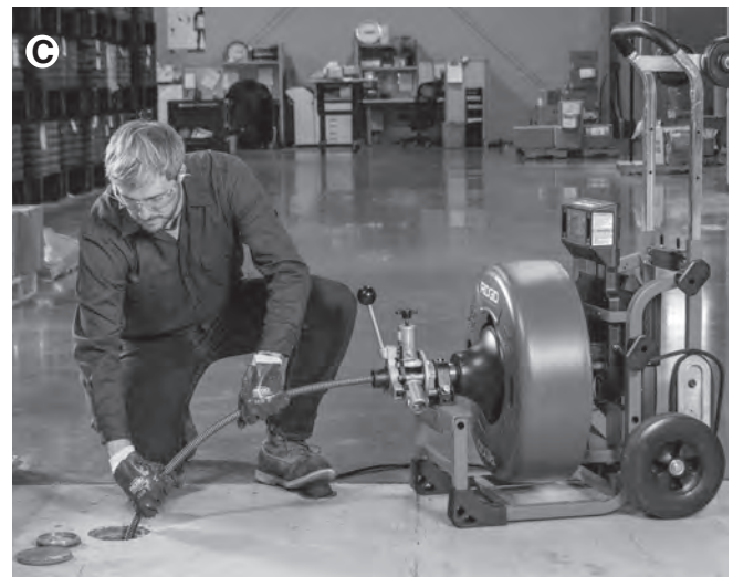
Figure 20A,B,C – Avancement manuel du câble
