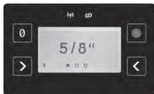
a. Écran de section de câble b. Écran de longueur de câble Figure 11 – Saisi des paramètres de câble
