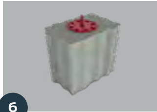
Pour concrete to top of sleeve
