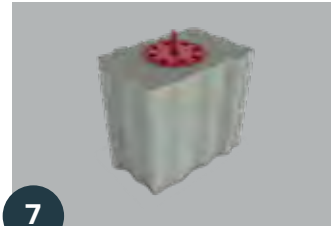
7 Pour concrete to top of sleeve
